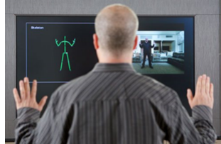
Abbildung 2: Person wird von der Kinect in Echtzeit als virtuelles Skelett dargestellt.
