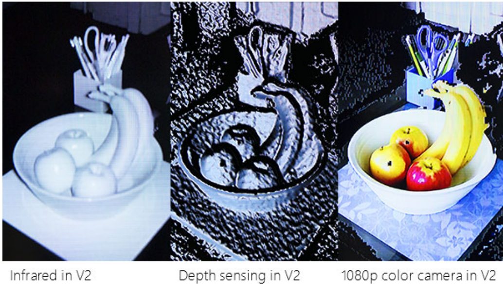
Abbildung 4: Infrarot-, Tiefen- und Farbbild aufgenommen mit der Kinect for Windows v2
